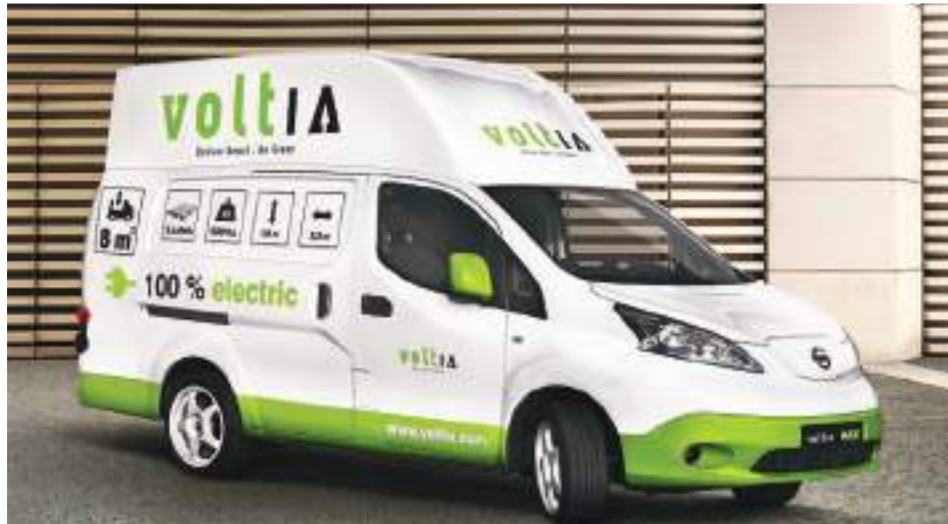
■ Slovenský projekt Voltia stojí za úpravou elektr. dodávok Nissan e-NV200 na vyšší objem nákladného priestoru
