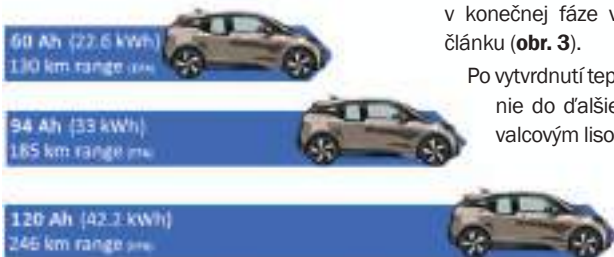
Obr. 1 Vývoj batérií sa dá veľmi dobre dokumentovať na modeli BMW i3, v každej z generácií je batéria s väčšou kapacitou, ale pri zachovaní rovnakých rozmerov a hmotnosti
